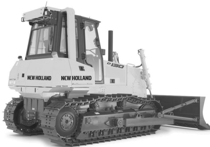
Tractor de oruga o “Bulldozers”
