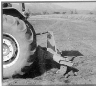
Labor de Subsolado
